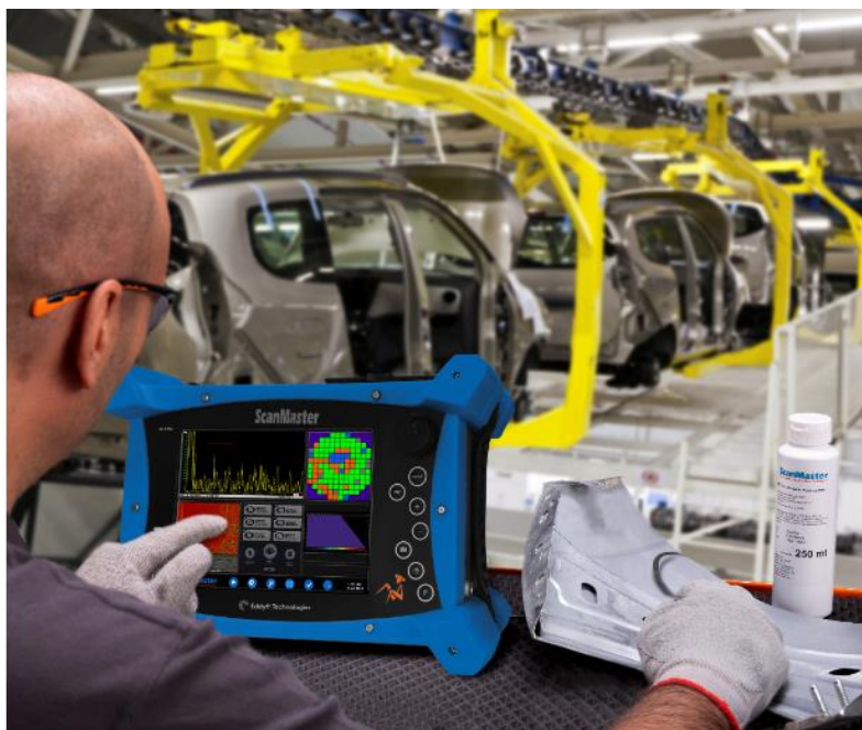
Inspección puntos de soldadura con equipo phase array de ScanMaster
