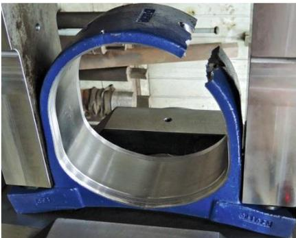
Las hipótesis de la simulación FEA se basaban en resultados de alojamientos cargados hasta el punto de rotura. Para determinar estas cifras, se seleccionaron alojamientos de Timken de distintos tamaños y se cargaron en una prensa hidráulica con herramientas universales especializadas. Después, se realizaron pruebas con diferentes cargas.
