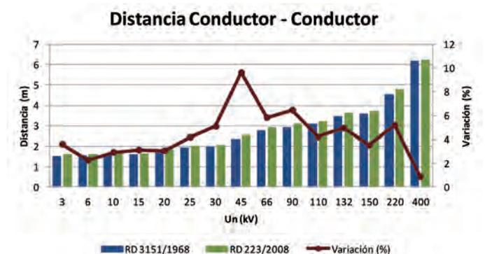
Fig. 4: Distancias de seguridad entre conductores según ambos reglamentos
