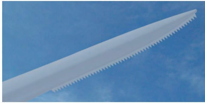
Fig. 5: Pala de una turbina eólica con el dispositivo Serrated trailing edge
