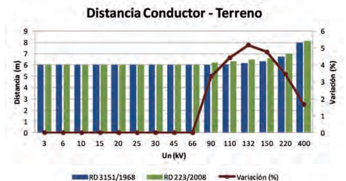
Fig. 3: Distancias de seguridad conductor-terreno según ambos reglamentos
