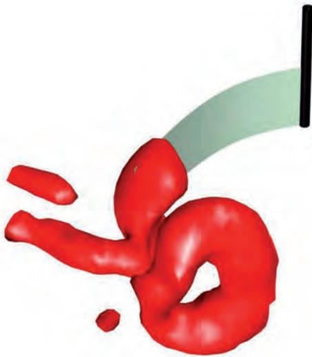
Fig. 3: Estela aguas abajo de una lámina flexible utilizada para simular el nado ondulatorio. La lámina es actuada por un motor que impone una señal senoidal de posición angular en su canto de ataque. Las estructuras que aparecen son isosuperficies de vorticidad (criterio Q) derivadas de medidas realizadas mediante el uso de velocimetría volumétrica o DDPV (Huera-Huarte et al., 2015)
