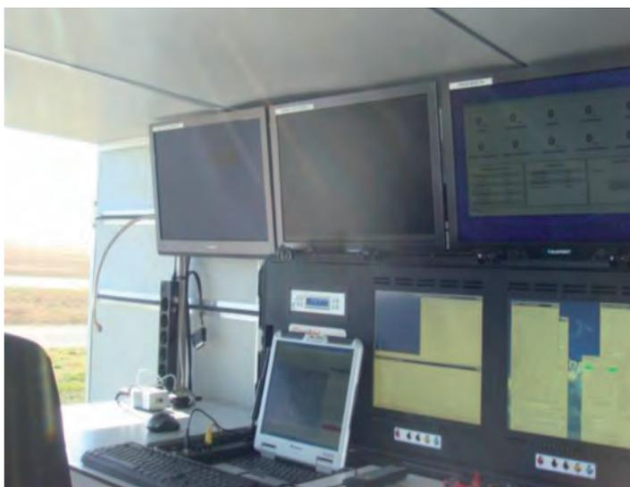
Figura 3: Estación de control terrestre del UAV K50 de la compañía USOL. (Fuente: congreso UNVEX14)
